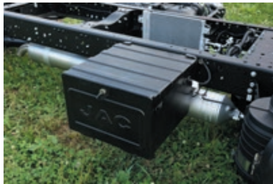
Аккумуляторный ящик с замком. Реле разрядки не позволит батареям умереть
