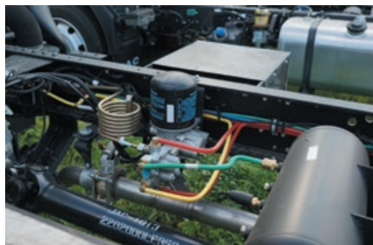
На новом модельном ряду влагоотделитель вынесут наружу рамы
