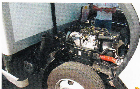
▲ Под кабиной младшего грузовика JAC N56 установлен собственный турбодизель Green Jet HFC4DE1 Евро-5 объемом 2.8 л, развивающий 116 л. с. и 250 Нм
