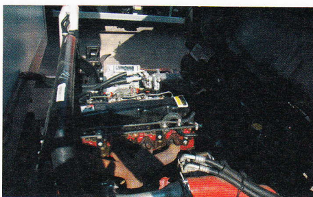
▲ В более крупных грузовиках N75 (N120) применяется известный по «Валдаю» мотор Cummins ISF 3.8 мощностью 156 (166) л. с. и крутящим моментом в 490 (592) Нм
