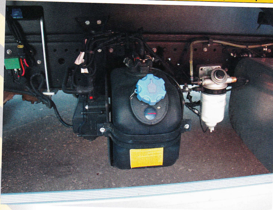
▲ Требования стандартов Евро-5 достигается за счет применения системы мочевиной нейтрализации выхлопных газов
